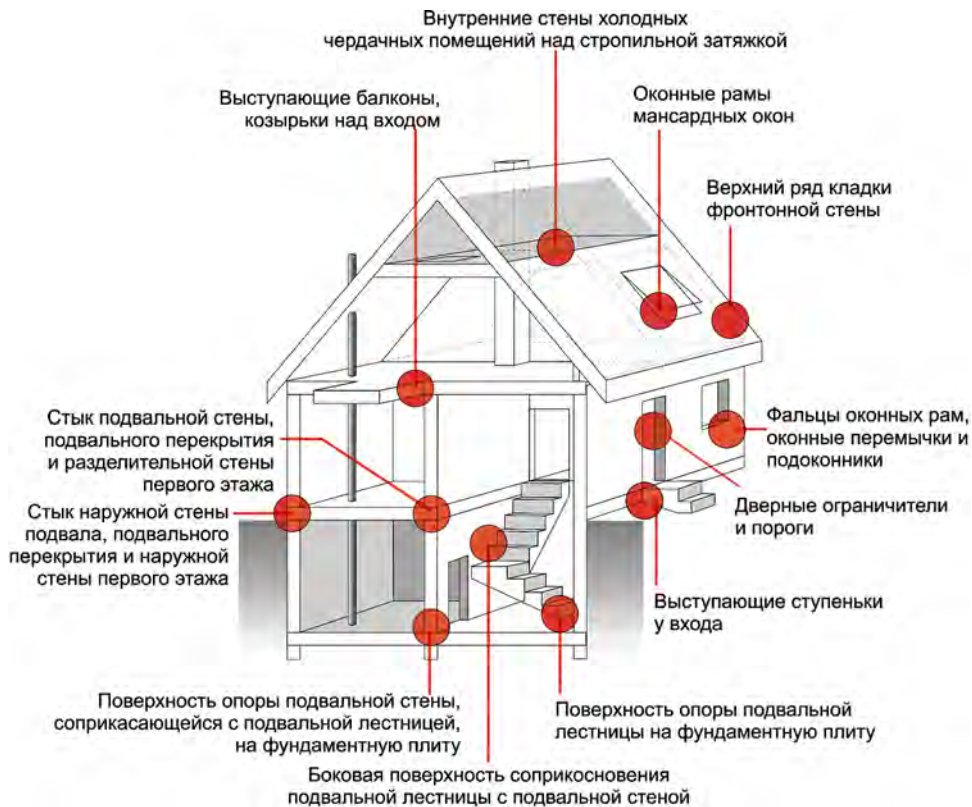
Рис. 2.13. «Тепловые мостики», наиболее часто встречающиеся в жилых домах. В этих местах требуется предпринимать особые меры предосторожности. Им уделяют особое внимание при проектировании
