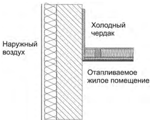
Рис. 2.25. Устранение «теплого мостика» в месте стыка наружной стены с чердачным перекрытием за счет установки вертикальной внутренней теплоизоляции в чердачном помещении
