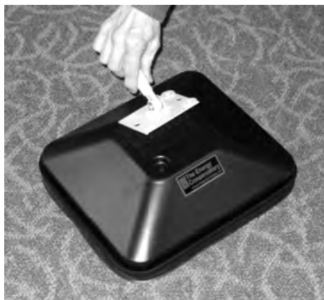
Рис. 2.38. Диагностическая заглушка для проверки герметичности воздуховодов систем вентиляции и кондиционирования
