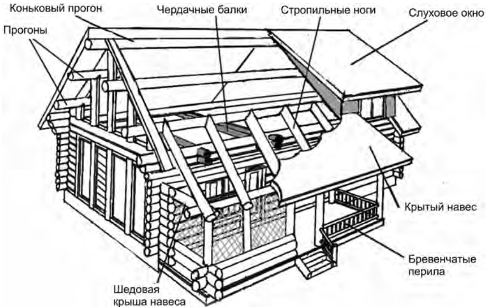
Рис. 5.2. Конструктивные элементы скатной крыши
