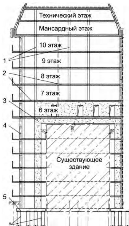
Рис. 1.2. Принципиальная схема конструктивных решений ДВЗ
